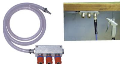
Standardkupplungen sind gestattet bei Montage höchstens 1,2 m über Boden, senkrecht nach unten, oder max. 45° schräg nach unten.
