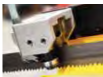
Sägebandführung aus Hartmetall
