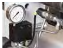
Spanndruckregelung des Spannstocks (Option)
