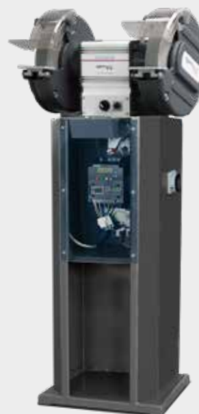
Abb.: Beispiel Varioumbau mit Unterbau mit Muster-Sichtfenster GU 20
