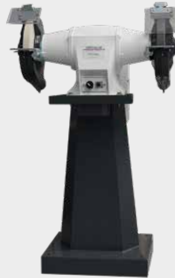
Abb.: Beispiel Varioumbau mit GZ 25D
