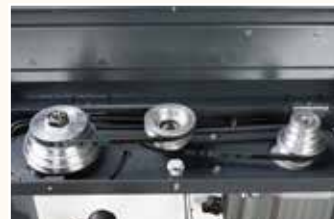
Abb. Riemenantrieb DQ 22. Bei DQ 14/18 zwei Riemenscheiben
