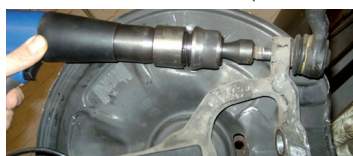
Spurstangenkopf austreiben (mit Nr. 8760)
