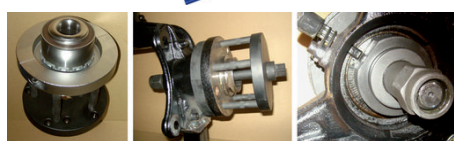
Einbauvorbereitung Lager- \varnothing 72 mm, Ausbau Lager- \varnothing 85 mm (Nabenseite), Ausbau Lager- \varnothing 85 mm (Rückseite)
