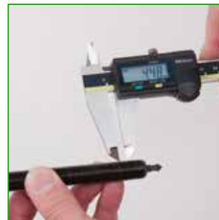
c Messen Sie die Länge über 3 Gewindegänge.
