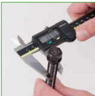
a Messen Sie den Spindeldurchmesser.
