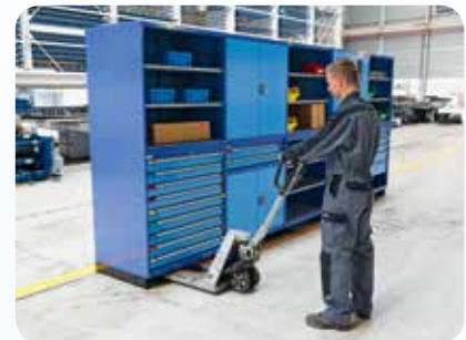
Schritt 3 Platzieren der Module mittels integriertem Hubwagensockel
