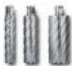
HSS NOVA 100 KERNSBOHRER MIT 3/4" WELDON-AUFNAHME Hohe Standzeit. Metrische Abmessungen, Schnitttiefe 100 mm. Nicht für Überlappungsbohrungen geeignet.
