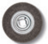
STAHLBÜRSTE Ø 250 mm x 60 mm, mit sehr hoher Drahtzugfestigkeit für besonders wirtschaftlichen Einsatz, Aufnahmebohrung Ø 51 mm. 0,2 mm Drahtstärke für dünnwandige Rohre und Profile. 0,35 mm Drahtstärke für universellen Einsatz. 0,5 mm Drahtstärke für dickwandige Rohre und Profile und hoher Entgratleistung. Stahl-Ausführung
