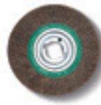
STAHLBÜRSTE Ø 250 mm x 60 mm, mit sehr hoher Drahtzugfestigkeit für besonders wirtschaftlichen Einsatz, Aufnahmebohrung Ø 51 mm. 0,2 mm Drahtstärke für dünnwandige Rohre und Profile. 0,35 mm Drahtstärke für universellen Einsatz. 0,5 mm Drahtstärke für dickwandige Rohre und Profile und hoher Entgratleistung. Edelstahl-Ausführung
