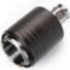
GEWINDEBOHR-SCHNELLWECHSELFUTTER GR. 3 MIT QUICKIN MAX-/ WELDON 32-AUFNAHME Nur einsetzbar für Magnet-Kernbohrmaschinen mit Linkslauf-Funktion. Für Gewindebohrer nach DIN 374/376, in Verbindung mit Gewindebohr-Einsätzen mit oder ohne Sicherheitskupplung von M22 - M36.
